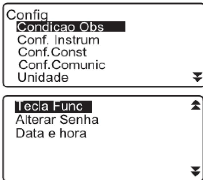
**Condicao Obs:** configuração dos modos de medição de ângulos (horizontal e vertical) e distâncias (horizontal e vertical), correções, compensador e leituras;
