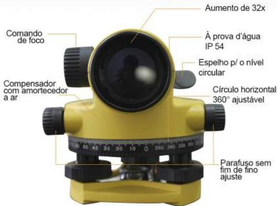
Nível óptico Xpex AT-32, possui compensador magnético, garantindo sua estabilidade.
