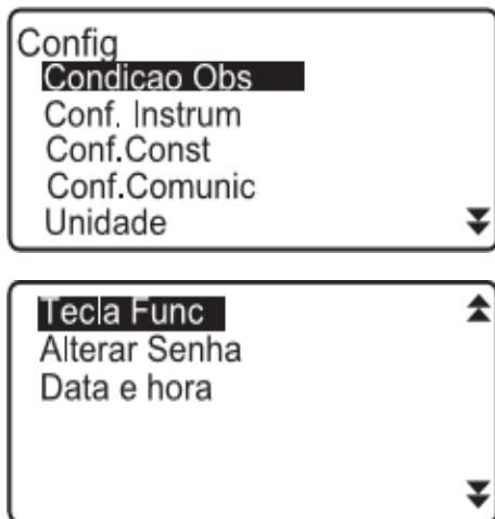
**Condicao Obs:** configuração dos modos de medição de ângulos (horizontal e vertical) e distâncias (horizontal e vertical), correções, compensador e leituras;
