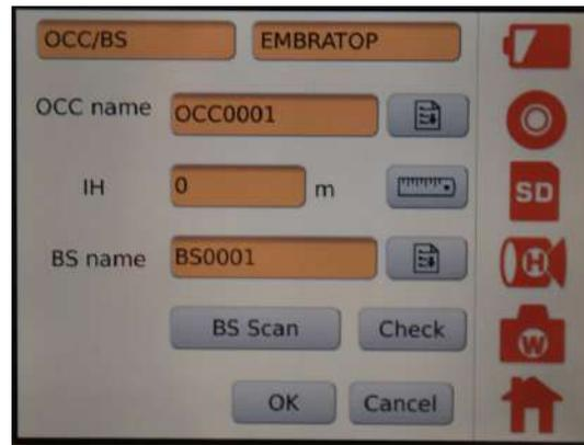
3. Clique sobre o campo do valor da altura do instrumento e insira a altura inclinada medida.
