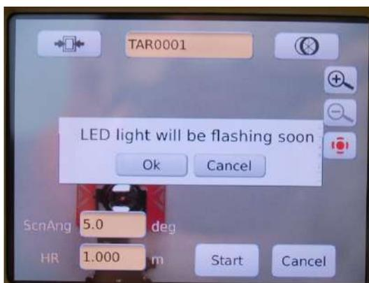
6. O instrumento começará a detecção do prisma;
