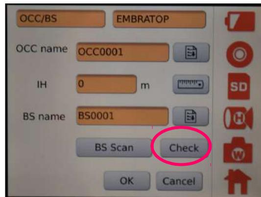
11. Será apresentada a tela ao lado, onde o valor apresentado em **Cal HD** é a distância calculada entre as coordenadas dos pontos de ocupação e de ré; e o valor apresentado em **Raw HD** é a distância medida pelo instrumento no momento do escaneamento do prisma;
