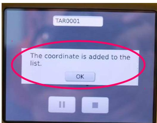
8. Ao instalar o instrumento no próximo ponto, basta buscar as coordenadas na lista de pontos.
