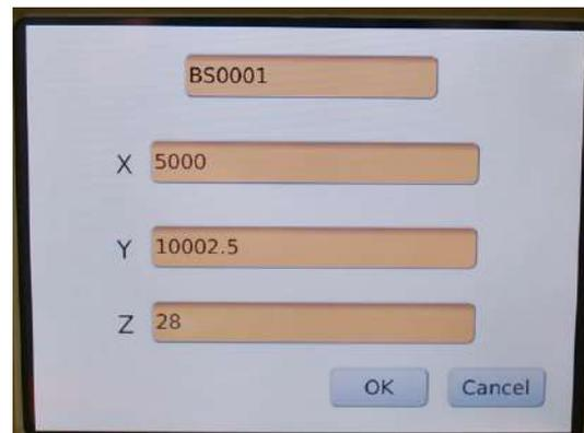
2. Após inserida as coordenadas, clique no botão BS Scan para iniciar o escaneamento do ponto de ré;
