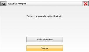
**5.** O *MAGNET Field* irá conectar ao receptor via Bluetooth, assim que a conexão for realizada será exibido o ícone no GUIA EMBRATOP canto superior direito da tela;
