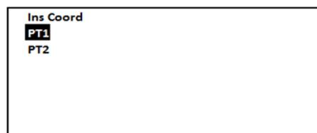
4. Insira os valores das coordenadas do **primeiro** ponto, ou pressione a tecla **F1 [LISTA]** e busque as coordenadas do ponto na memória interna do instrumento.
