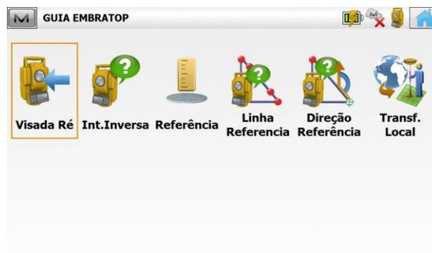
3. Na janela **Visada Ré**, em **Ponto Ocupado** defina o nome do ponto onde o instrumento está estacionado. Em **Ai**, insira a altura do instrumento.
