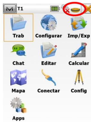
6. O **MAGNET Field** exibirá a janela para configuração do rádio do receptor **Rover**,
