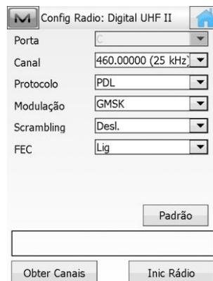
9. Após configurado o rádio, será exibido o ícone
