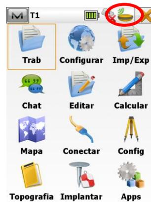
10. Para verificar qual a precisão em tempo real para o levantamento e/ou locação de dados, clique em **Topografia**;
