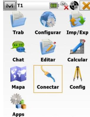
2. Verifique se o Perfil de Configuração dos receptores está correto, clique na opção **Base**, em seguida clique em **Conectar**;
