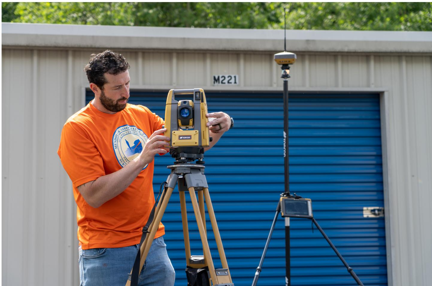
A Solução Híbrida inclui Receptores GNSS, Estação Total Robótica, Coletor de Dados e Programa MAGNET Field
