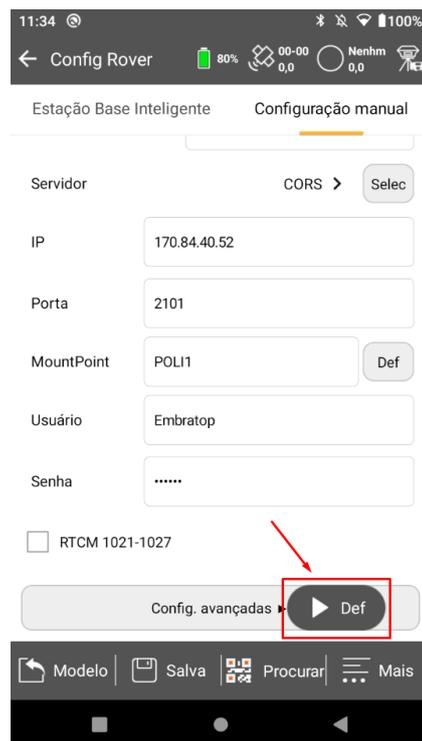
13. Será realizada a conexão ao Servidor configurado;
