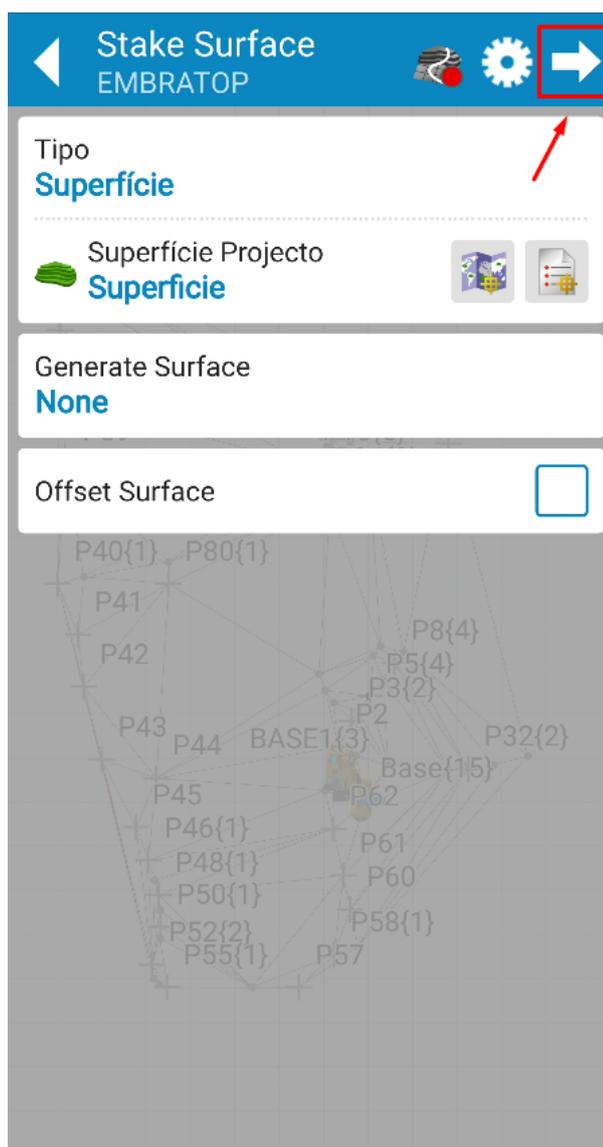
7. Clique no ícone
